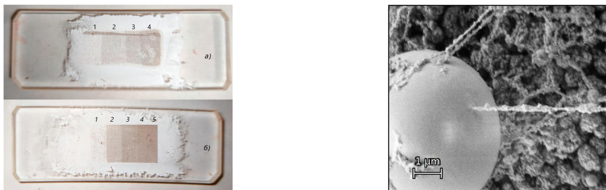
Рис. 9. Вид образцов при различных режимах лазерной обработки (а); Поверхность слоя \text{Bi}_4\text{Ge}_3\text{O}_{12} после лазерного облучения в течение 2 мкс (б).
