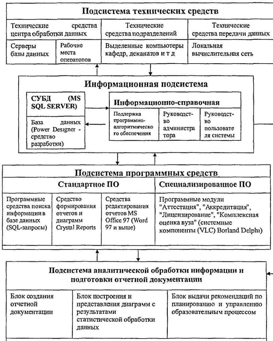
Рис 2 Функциональная структура комплекса программных средств информационно-аналитической системы контроля, планирования, управления образовательным процессом вуза
